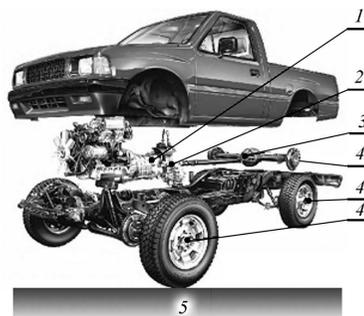
Рис. 3. Взаимодействие агрегатов в механизме. 1 – двигатель внутреннего сгорания, 2 – коробка перемены передач, 3 – передача крутящего момента на колёса, 4 – оси вращения, 5 – сцепление с дорожным покрытием
